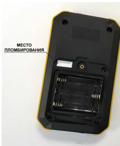
Рисунок 5 - Место пломбирования дефектоскопов ультразвуковых NOVOTEST UD2301-IP (UD2301-IP)
