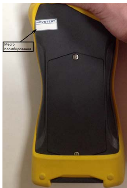
Рисунок 4 - Место пломбирования дефектоскопов ультразвуковых NOVOTEST UD2301 (UD2301)
