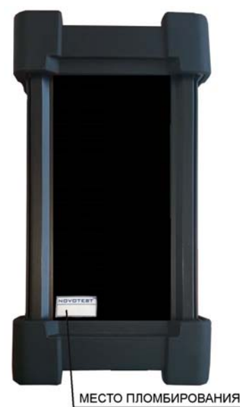
Рисунок 6 - Место пломбирования дефектоскопов ультразвуковых NOVOTEST UD2301-M (UD2301-M)
