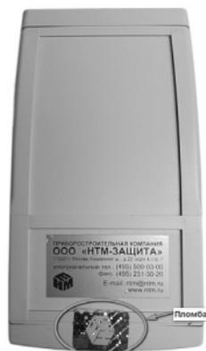
*Рис.2. Расположение пломбы фирмы-производителя на корпусе Радиометра.*
