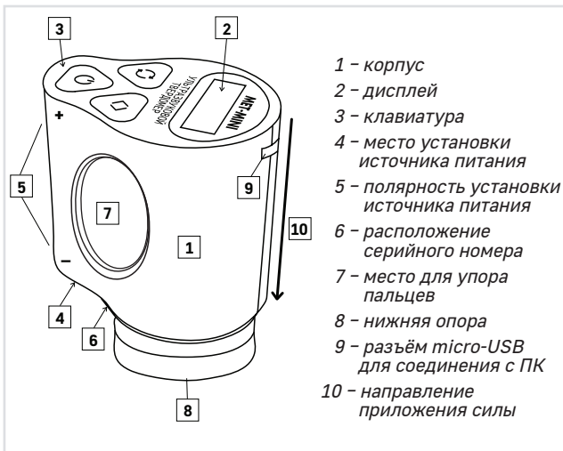
Рис. 1. Схема твердомера MET-MINI
