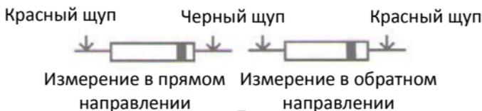
Если в режиме проверки на обрыв сопротивление цепи составляет ниже 40 Ом, срабатывает звуковой сигнал.
