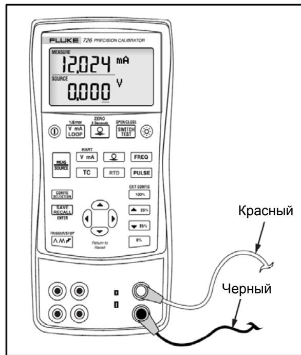
Рисунок 7. Измерение напряжения и силы тока выходного сигнала.
