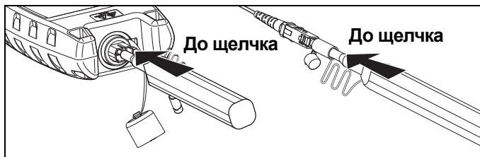
Рисунок 5. Использование механического устройства при очистке разъемов
