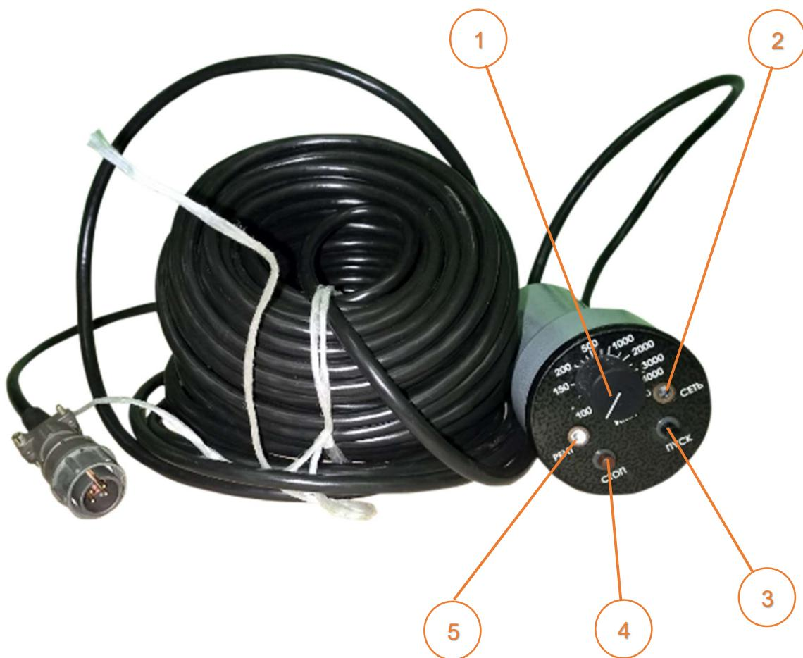
1 – Таймер экспозиции в виде счетчика импульсов.
