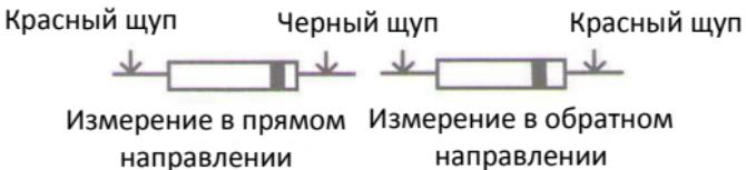
Если в режиме проверки на обрыв сопротивление цепи составляет ниже 40Ом, срабатывает звуковой сигнал.
