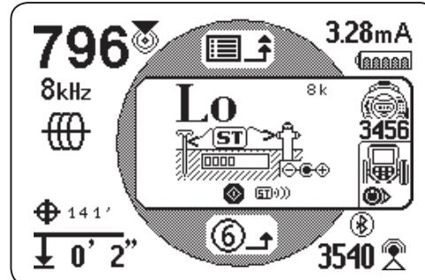
Если в зоне находится больше одного SeekTech передатчика с включенной функцией Bluetooth, то нажимая клавишу Стрелка влево , можно увидеть все доступные для подключения передатчики. Чтобы выбрать передатчик, которым надо управлять, нажмите на его серийный номер в списке, приведенном под символом Передатчик.
