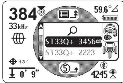
Как только произойдет подключение, передатчик включится автоматически. Когда устройства подключены, символ Bluetooth ® появится и на экране передатчика, и на экране приемника. Появившееся на экране передатчика изображение звена цепи подтверждает, что устройства подключены.
