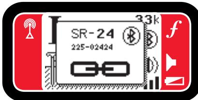
Если приемник ранее подключался к разным передатчикам, то устройство автоматически переберет все устройства из списка, которые были подключены ранее, и установит соединение с нужным устройством.
