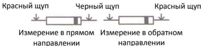
Если в режиме проверки на обрыв сопротивление цепи составляет ниже 150Ом, срабатывает звуковой сигнал.
