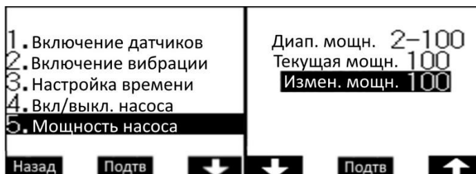
Рис. 6. Настройка мощности прокачки насоса
